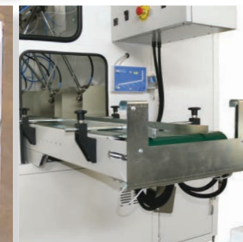
5 Sistema di intercettazione a fotocellula. Interception system by photobeam.
