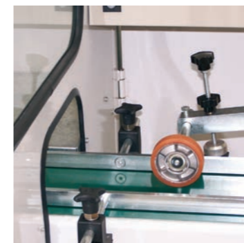
1 Sistema di intercettazione – ingresso pezzi. Interception system – part entrance.
