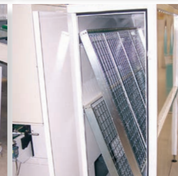
4 Grandi filtri di aspirazione. Big suction filters.
